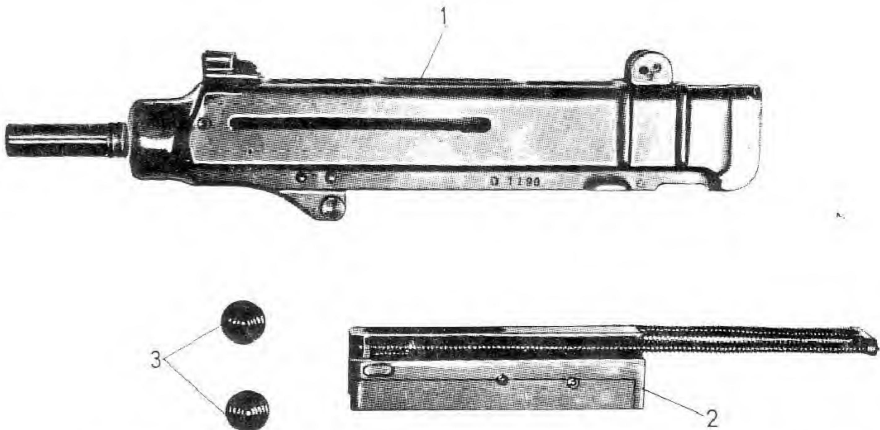
Sl. 27 – **Delovi sklopa vodice zatvarača sa zatvaraćem i opružnim povratnikom (rastavljeni sklopolovi):**
